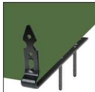
Eksempel av bruk av torvhaldskrok. Membran skal legges over og festes med skiver/skruer.
